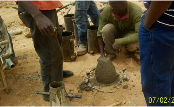
Mise en place du béton liquide dans le cône d'Abraham
